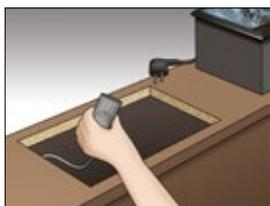
230 V Stromversorgung installieren und für ausreichend Luft im Bodenbereich sorgen.
