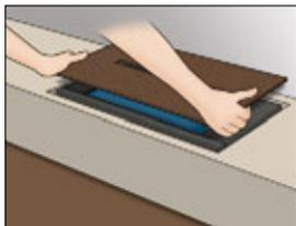
Nach dem Einsetzen des Tanks setzen Sie die bauseitige Abdeckplatte ein. Bei Steel-Fire-Top ist sie bereits im Lieferumfang enthalten (Inox oder Black).
