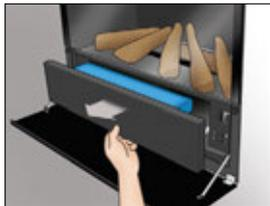
Öffnen Sie die Klapplade des Einbausatzes und anschließend die Schublade des Effektbrenners.
