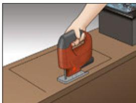
Öffnung entsprechend den inneren Abmessungen des "Mini" ausschneiden.
