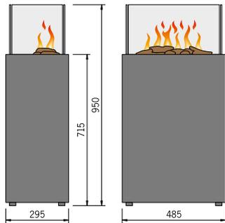
Bedienung (Befüllung, Revision) erfolgt von oben nach Abheben der Dekorholz-Abdeckung.
