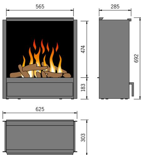
Bedienung (Befüllung, Revision) erfolgt über frontseitige Schublade.
