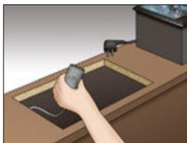
230 V Stromversorgung installieren und für ausreichend Zuluft im Bodenbereich sorgen.
