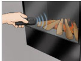
Fernbedienung von oben auf die rechte Seite des Gerätes richten und starten. Dies wird durch einen Signalton angezeigt.
