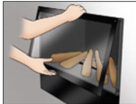
Klapplade schließen und Frontscheibe montieren.
