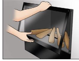
Klapplade schließen und Frontscheibe montieren.
