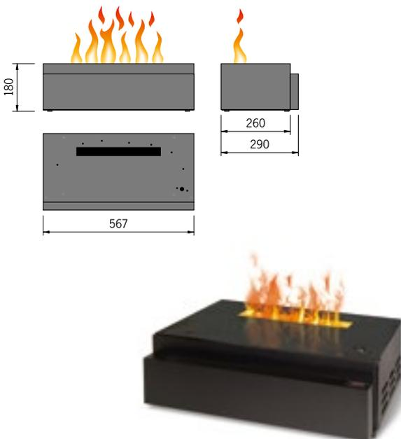
Bedienung (Befüllung, Revision) erfolgt über frontseitige Schublade.
