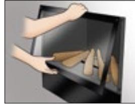
Klapplade schließen und Frontscheibe montieren.
