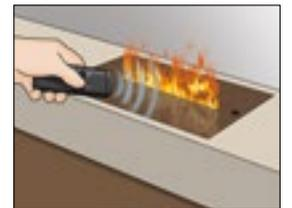
Halten Sie die Fernbedienung von oben auf die Sensoröffnung und starten Sie den Effektbrenner. Dies wird durch einen Signalton angezeigt.
