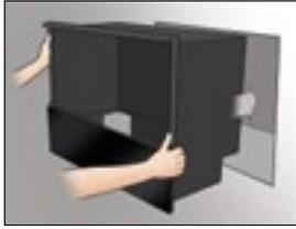
Einbausatz in die mit 230 V Stromversorgung ausgestattete Nische einschieben und befestigen.
