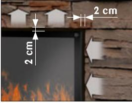
Achten Sie bei nachträglicher Wandverkleidung auf einen Mindestabstand von ca. 2 cm zum Gerät, damit eine ausreichende Luftzirkulation ermöglicht wird!
