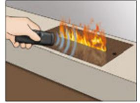
Halten Sie die Fernbedienung von oben auf die Sensoröffnung und starten Sie den Effektbrenner. Dies wird durch einen Signalton angezeigt.
