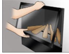
Klapplade schließen und Frontscheibe montieren.
