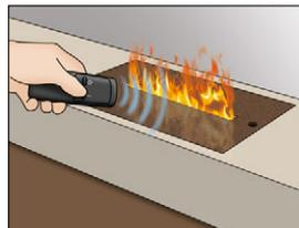
Halten Sie die Fernbedienung von oben auf die Sensoröffnung und starten Sie den Effektbrenner. Dies wird durch einen Signalton angezeigt.
