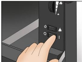
Nach dem Einsetzen des Tanks schalten Sie den Hauptschalter am Effektbrenner ein. Danach Schublade und Klapplade wieder schließen.
