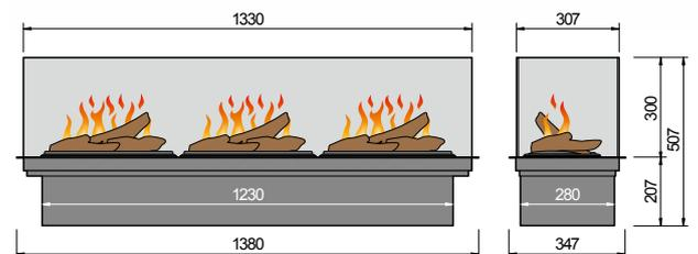
Bedienung (Befüllung, Revision) erfolgt von oben nach Abheben der Dekorholz-Abdeckung.
