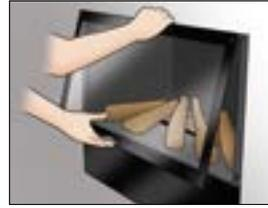
Klapplade schließen und Frontscheibe montieren.
