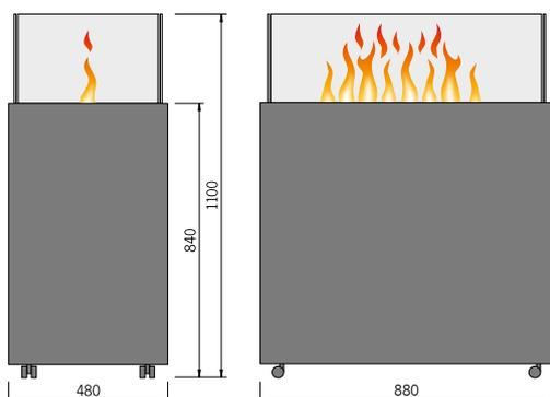
Bedienung (Befüllung, Revision) erfolgt von oben nach Abheben der Steel-Abdeckung.
