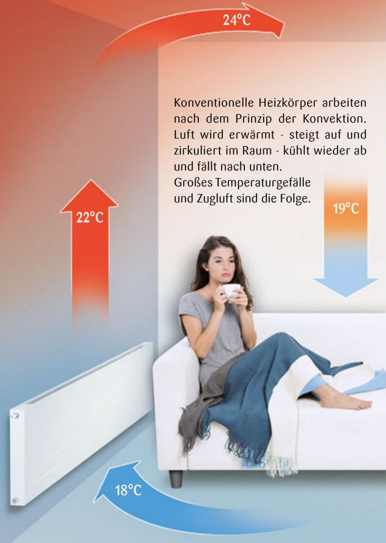
Konventionelle Heizkörper arbeiten nach dem Prinzip der Konvektion. Luft wird erwärmt - steigt auf und zirkuliert im Raum - kühlt wieder ab und fällt nach unten. Großes Temperaturgefälle und Zugluft sind die Folge.
